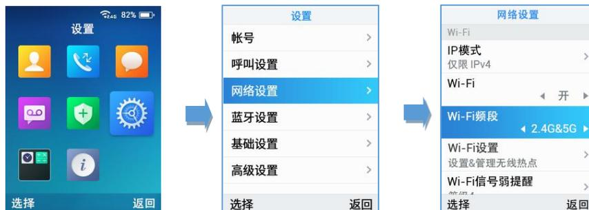
图 14 Wi-Fi 频段配置
